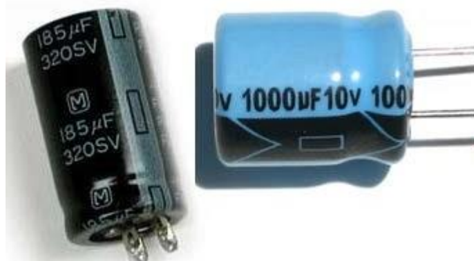
Tụ hoá ghi điện dung là 185 \mu F / 320 V; 1000 \mu F / 10V
