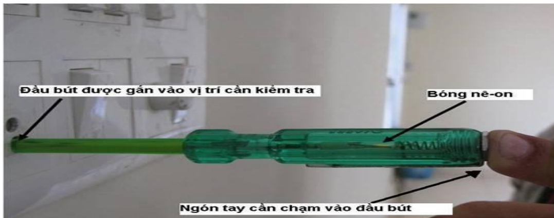
Hình 1.5: Cách sử dụng bút thử điện hạ thế
