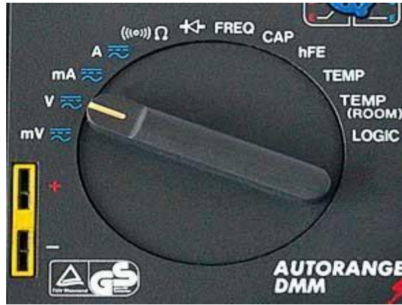
Hình 1.22: Đặt đồng hồ vào thang đo điện áp DC hoặc AC
