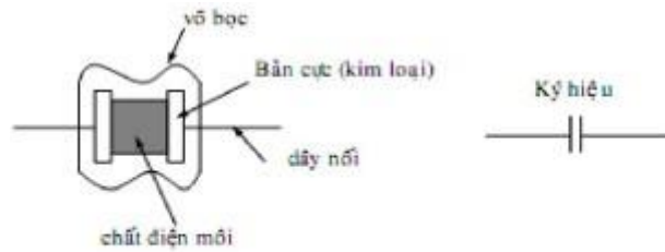
Hình 2-11. Cấu tạo và ký hiệu của tụ điện
