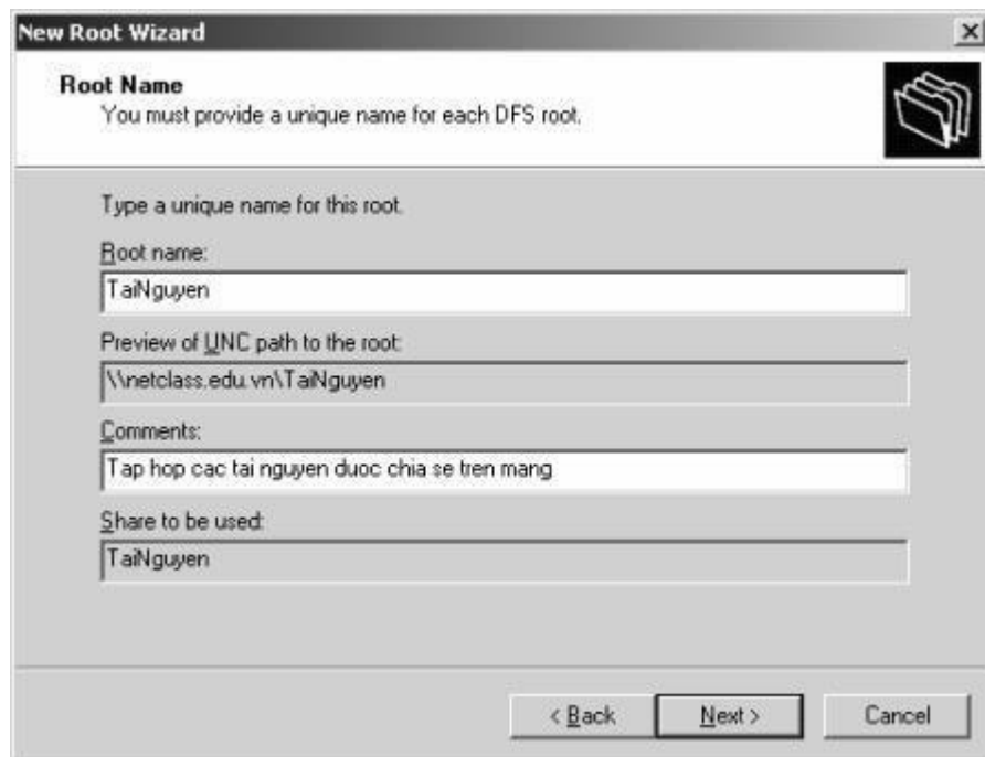
Hình 6.17 Khai báo tên chia sẻ gốc (Root Name) của hệ thống DFS
