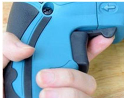
Hình 1-13. Nút đảo chiều của máy khoan
