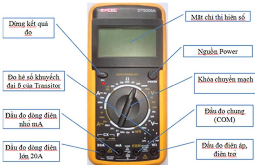
Hình 1-22. Hình ảnh kết cấu mặt ngoài của đồng hồ số
