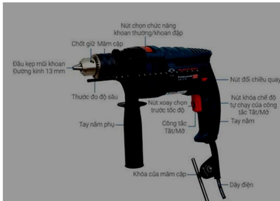
Hình 1-11. Cấu tạo máy khoan điện
