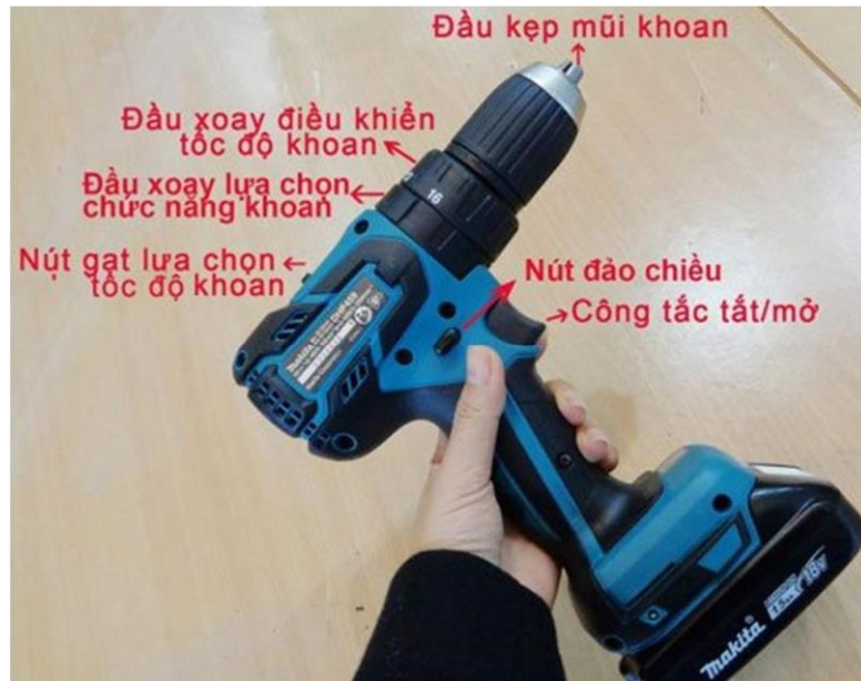
Hình 1-7. Cấu tạo của máy khoan pin - Cách sử dụng khoan pin cần tiến hành theo các bước sau:
