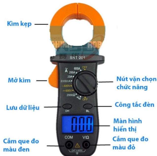
Hình 1-23. Hình ảnh kết cấu mặt ngoài của ampekìm
