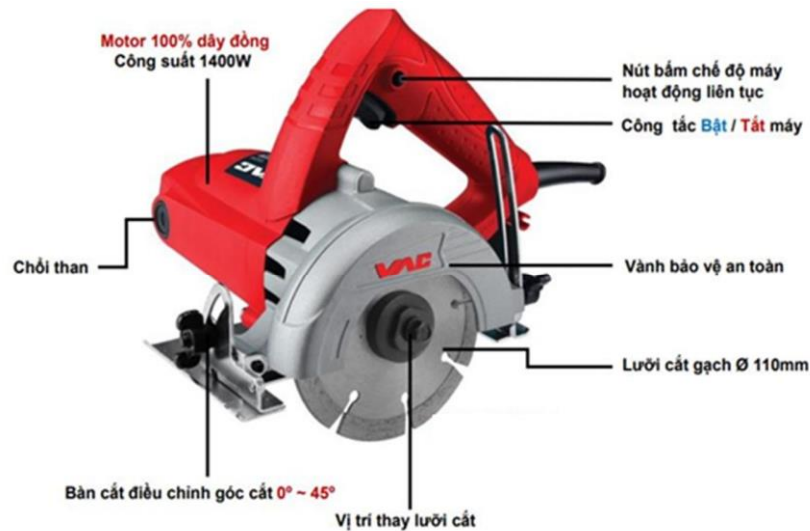
Hình 1-17. Cấu tạo máy cắt gạch
