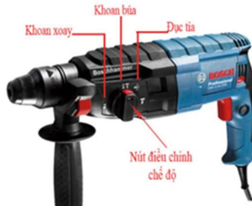
Hình 1-15. Núm chọn chế độ ở máy khoan bê tông
